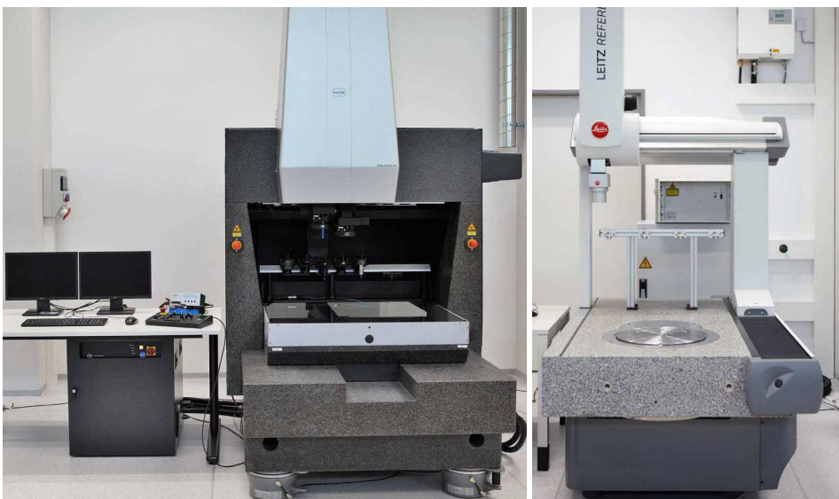
Verwendete Messsysteme: Links Werth VideoCheck HA mit taktilen Messkopf, Video- und Lasersystem sowie einem chromatischen Weisslichtsensor, rechts Leitz Reference HP für taktilen und berührungslose Erfassung mittels HPO-Sensor (Fotos: NTB/PWO)
