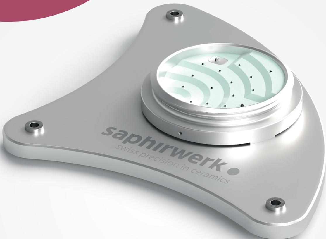
**A**n Prüfnormale zur Kalibrierung optischer Messsysteme werden besondere Anforderungen gestellt. Werkstoffe und Bearbeitungsverfahren wurden von Saphirwerk speziell dafür entwickelt. Die optischen Eigenschaften sind exzellent. In Kombination mit der einzigartigen Formgenauigkeit einer Saphirwerk-Kugel, entstehen Prüfnormale von aussergewöhnlicher Leistungsfähigkeit.
